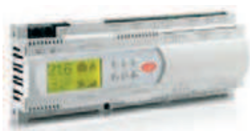
Scheda di controllo unità Unit management electronic board
